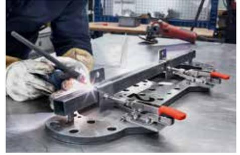
**Sistema di serraggio ad asta di spinta con piastra di base orizzontale STC-IHH**
