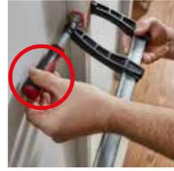
**La sujeción frente a superficies cerradas** no es posible con un tornillo de apriete convencional o una prensa de palanca ya que la falta de espacio impide manipular la empuñadura.
