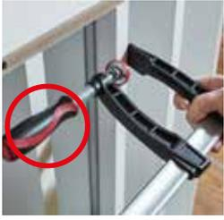
**La sujeción de pequeños listones** puede resultar complicada si se emplean tornillos de apriete convencionales o prensas de palanca ya que la empuñadura impedirá su correcta colocación.
