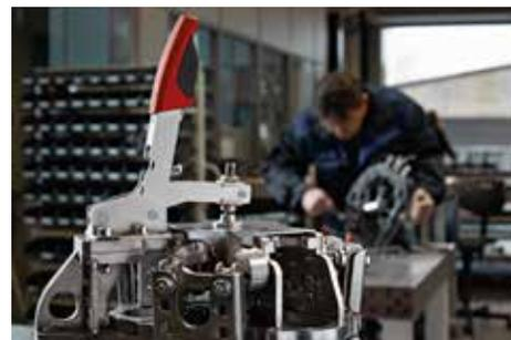
**Sistema di serraggio orizzontale con piastra di base orizzontale STC-HH**
