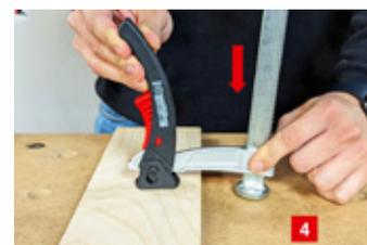
**NEW Spannwerkzeug-Set zum Arbeiten auf dem Tisch MFT-A**
