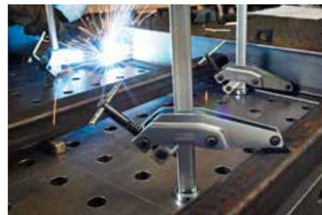
**Зажимный элемент с различной глубиной захвата TWV**
