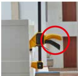
**Il rischio di danneggiare un pezzo e di subire delle lesioni** aumenta quando si lavora in aree di dimensioni ridotte, se gli strumenti di serraggio sono utilizzati con componenti sporgenti.
