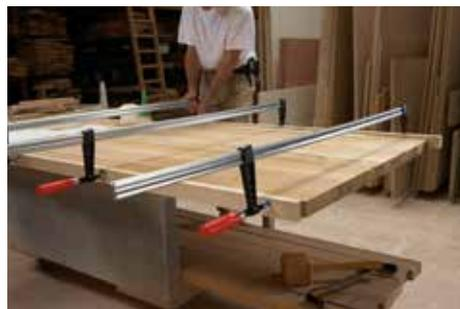
**Защита от проскальзывания, стабильная профилированная направляющая – зажимное усилие до 6000 Н**
