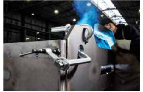
**Profil de rail optimisé – puissance de serrage jusqu'à 12 000 N
