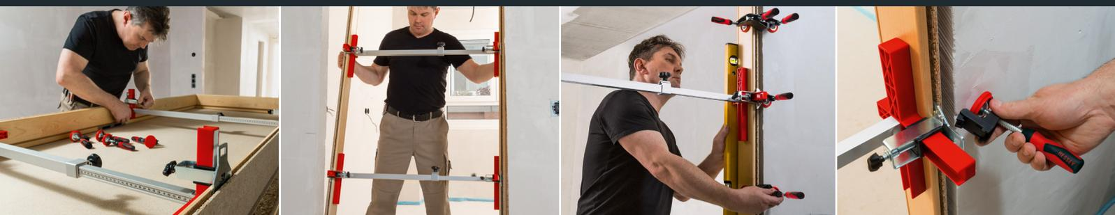
Dos juegos de acción con herramientas de montaje – para la alineación y el apoyo precisos de los marcos de puerta
